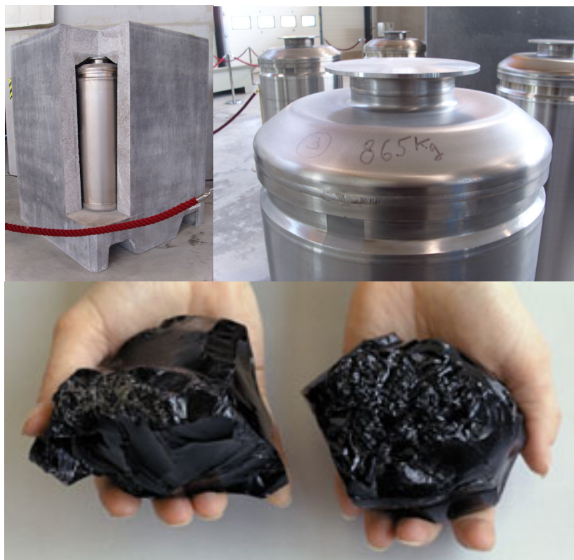
Fig.4 - Contenitori universali per scorie vetrificate e vetri (di tipo vulcanico) per il contenimento delle scorie (di tipo R7T7)
